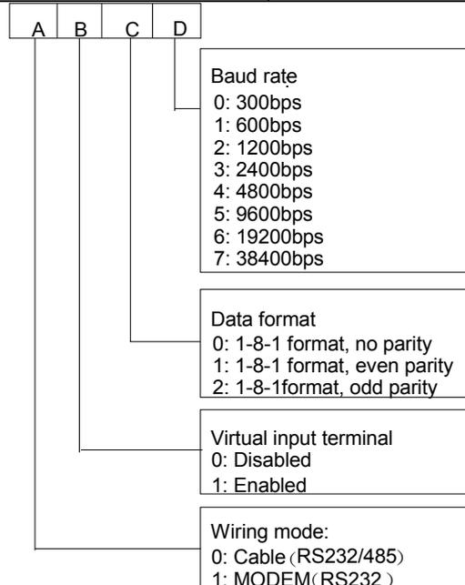
Fig. 5-69 Communication parameters
