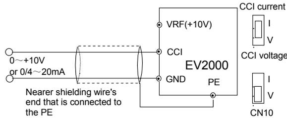
Fig. 3-15 Wiring CCI
