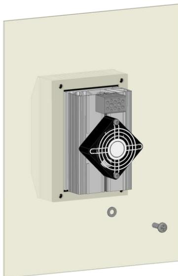
Ansicht von innen: das Kühlgerät mit vier Linsenkopfschrauben M5x16 mit Unterlegscheibe befestigen (5 Nm)
